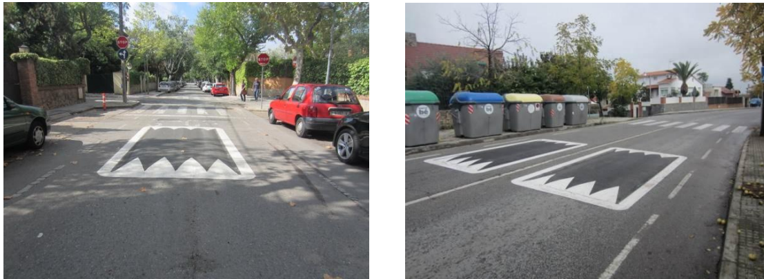
Imatge 64. Exemples de coixins berlinesos d'asfalt. Municipi de Sant Cugat del Vallès
