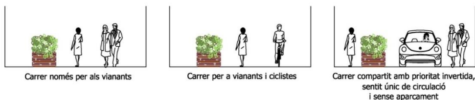
Figura 13. . Possibles seccions per a carrers amb menys de 7 m d'amplada
