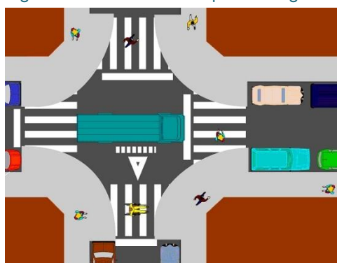
Figura 31. Intersecció compacta i segura
